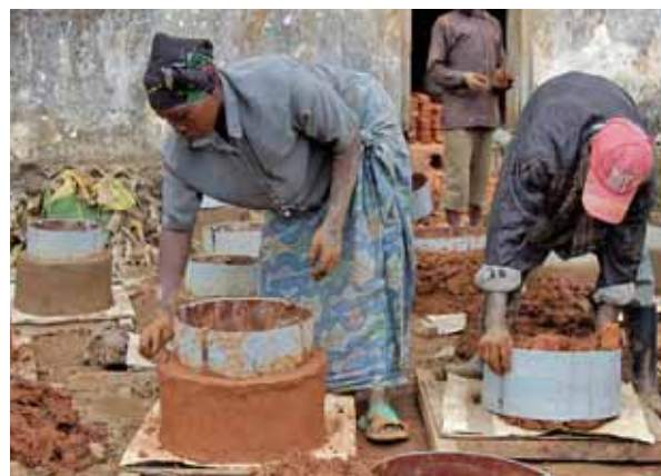
Pour réduire l'utilisation de bois énergie, des organisations telles que Mercy Corps et WWF forment les populations rurales et les PDI à la construction de foyers améliorés et à la fabrication de bio-briquettes (Rugari, Nord Kivu)
