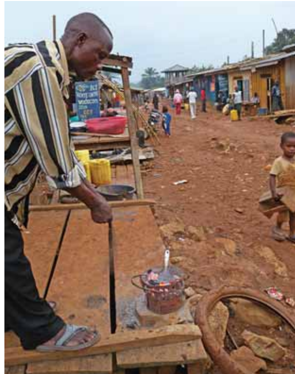
Un marchand d'or chauffe des amalgames d'or contenant du mercure sur la route juste à côté de son magasin. Comme la combustion se fait en plein air les vapeurs toxiques sont rejetés directement dans les rues bondées où jouent des enfants
