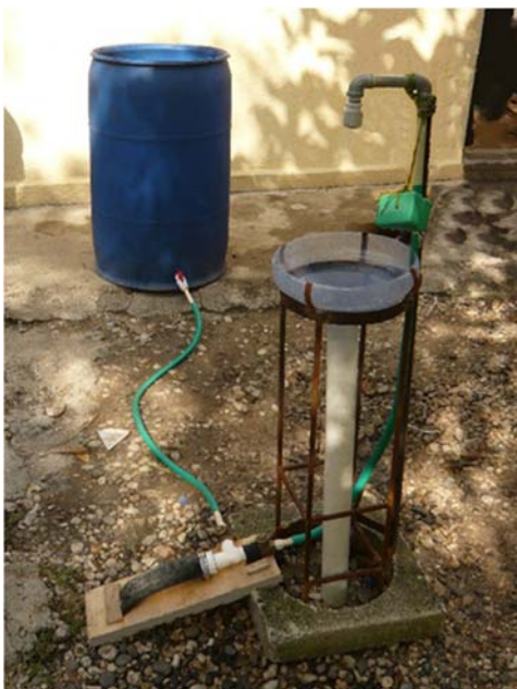
FIGURE 10: EXEMPLES DE POSTES DE LAVAGE DE MAINS SIMPLES ET ECONOMIQUES EN EAU
