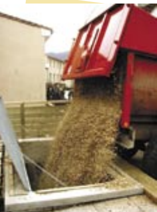
Livraison de plaquettes dans le silo
