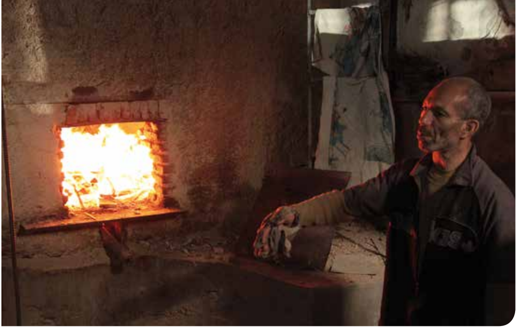
Visite au Hammam de Badr (Casablanca). La combustion de bois sec offre les meilleures propriétés calorifiques.
