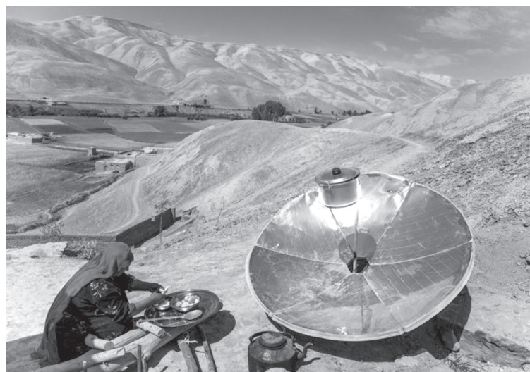
Cuiseur à énergie solaire. Photo Solidarités International
